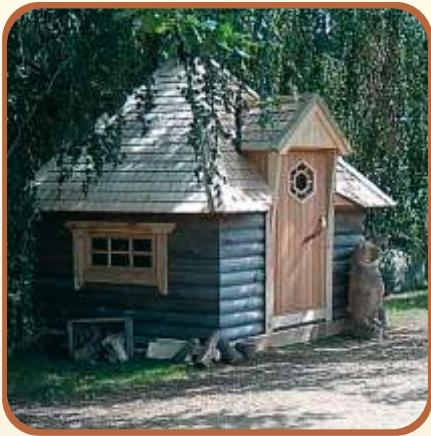
**Stěny** - 120mm kulatá stěnovice (půlkuláč) z finské borovice. Výška stěny činí cca 128 cm. Stěnové prvky jsou upevněny systémem táhla.
